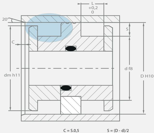
Ensemble joint chevron qui peut être monté dos à dos pour des applications double effet, dans des environnements hydrauliques lourds.
