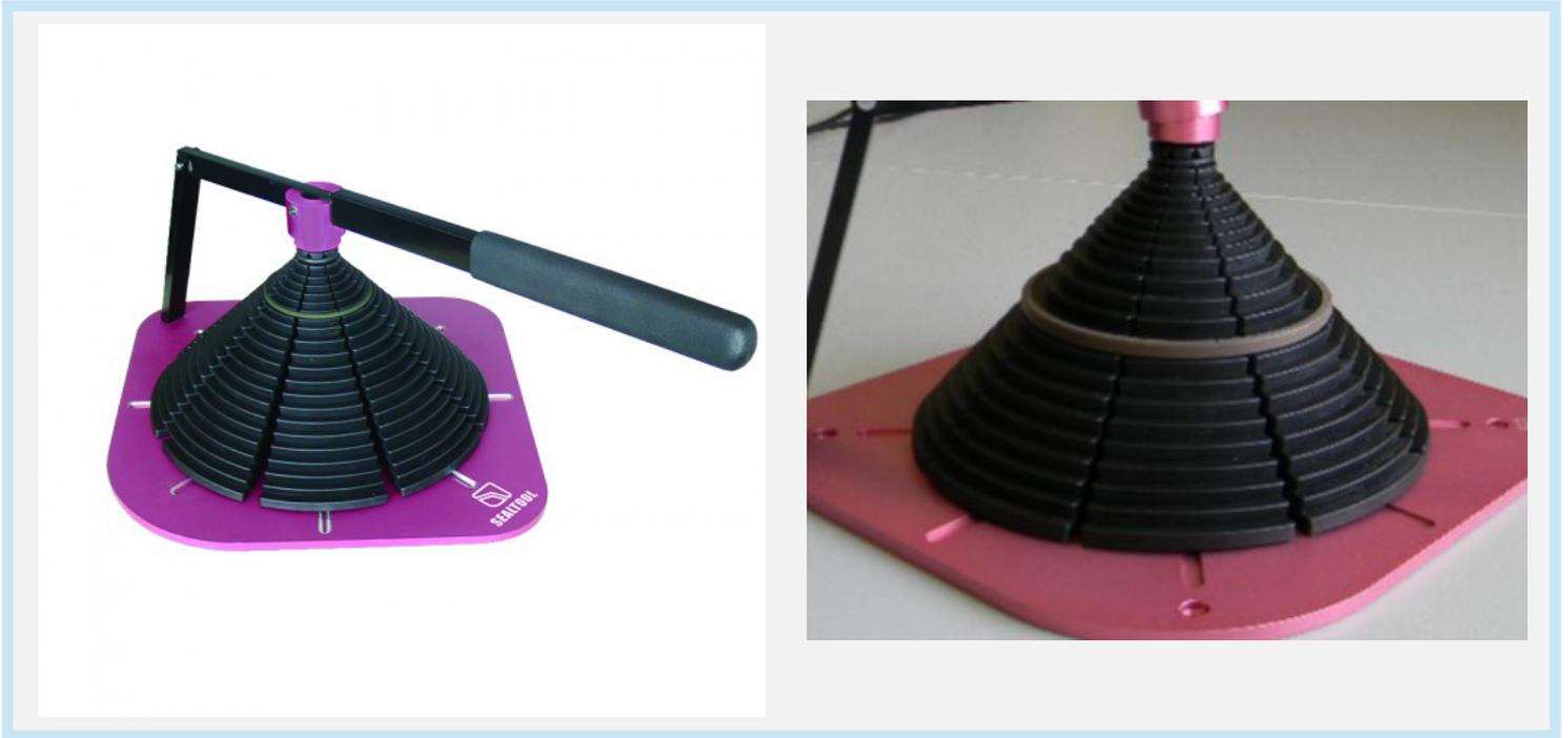
CONC : Après échauffement de la bague PTFE du composite de piston à 120°C pendant 2 ou 3 min, utilisez le cône d'extension pour agrandir cette bague suffisamment pour pouvoir la monter au-dessus du piston sans la détériorer. (Mini 40mm à maxi 320mm).
